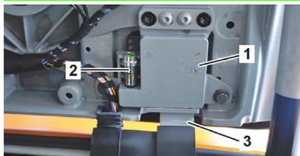
La SLS AMG è dotata di un sistema di sicurezza che provvede al disaccoppiamento delle cerniere delle porte dai bracci delle cerniere se la vettura dopo un incidente rimane in posizione capovolta. In ciascuna cerniera porta (1) è disposto un dispositivo di scatto pirotecnico (2) che viene attivato dalla centralina di comando sistemi di ritenuta. Dopo l'apertura della serratura porta le porte possono essere sfilate dai bracci delle cerniere (3).
