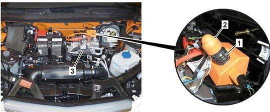
高電壓關閉裝置位在引擎室左側的冷卻壓縮機 (3) 上方 (以行車方向來看)。
