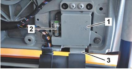
SLS AMG 配有安全系統，發生事故後若因翻覆而使車頂受損變形，該系統即會將車門鉸鏈從鉸鏈臂脫離。在每個車門鉸鏈 (1) 皆設有以火藥作動的觸發器 (2)，並由乘員防護系統控制器進行觸發。解開門鎖後，即可將車門從鉸鏈臂 (3) 處拉開。
