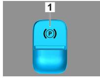
按下選檔桿 (1) 上的開關 P。電動手煞車即自動啟動。
