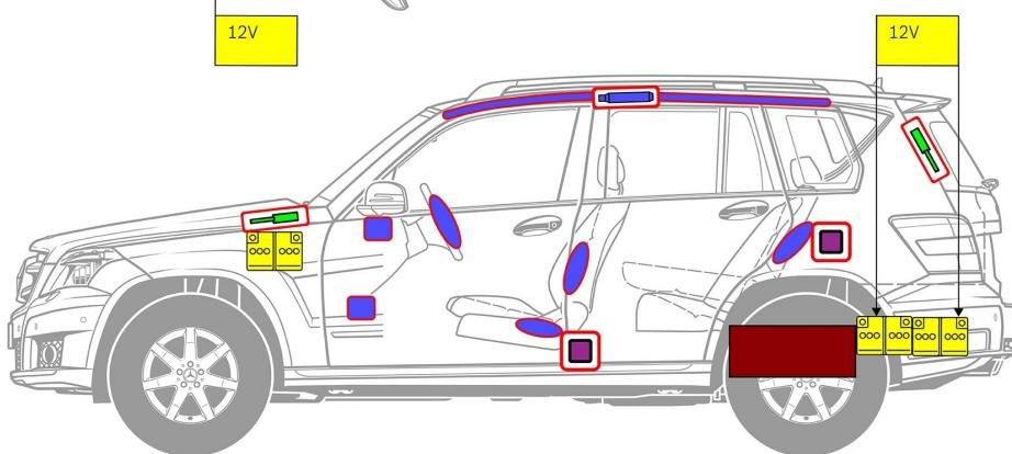
① 汽油引擎上的車載電瓶、自 2009 年 12 月 1 日起 4 汽缸及 6 汽缸柴油引擎的左駕車輛
