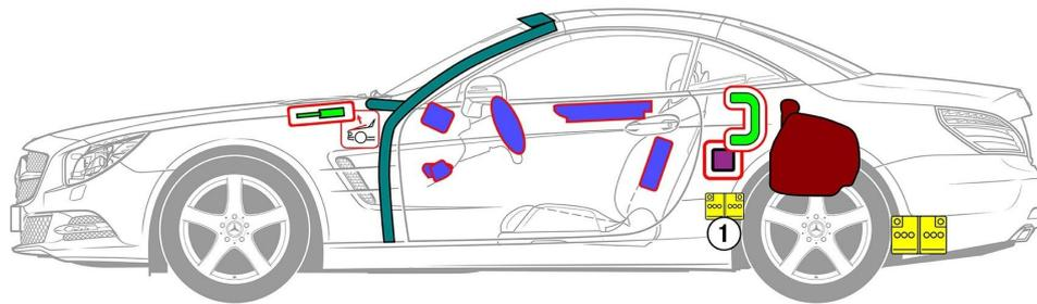
① ECO 引擎怠速節能啟閉功能的輔助電瓶
