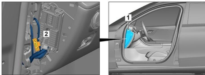
拆下蓋板 (1)。從標記點 (2) 處切斷電纜。
