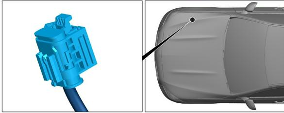
高壓斷開裝置位於行駛方向右側的發動機艙內。
