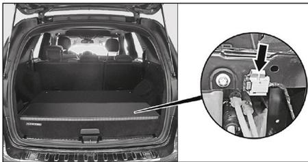
高電壓關閉裝置位於行李箱內高電壓電池的護蓋下方。
