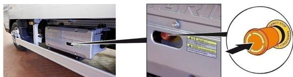
緊急關閉按鈕位於高電壓電瓶側飾板
