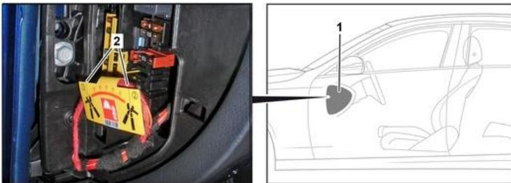
カバー(1)を取り外します。印をつけた箇所(2)でケーブルを切断します。
