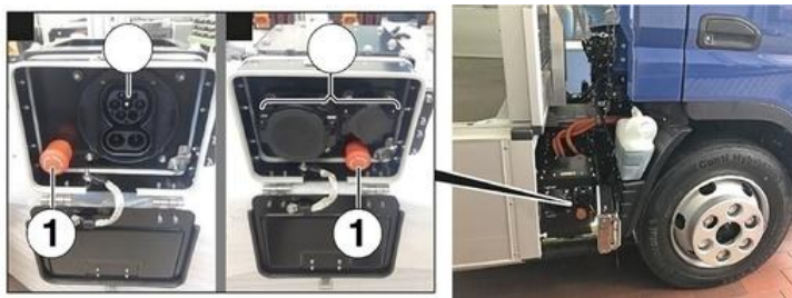
1 緊急停止ボタン
