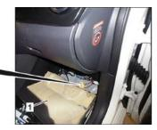
レッグ・ルーム・トリム (1) を後ろへ倒します / ケーブルをマークの箇所 (2) で切断します
