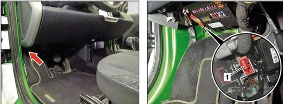
Il dispositivo di disinserimento alto voltaggio si trova sul lato inferiore della plancia portastrumenti in direzione di marcia a sinistra.
