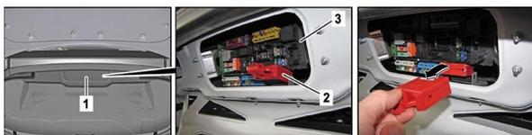
Sotto lo sportello di copertura della scatola fusibili e relè sulla parete posteriore nel bagagliaio si trova il dispositivo di disinserimento alto voltaggio.
