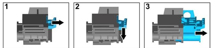
Il dispositivo di disinserimento dell'alto voltaggio si trova nel vano motore lato passeggero.
