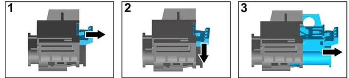
Sotto la copertura della cavità del bagagliaio nella parte posteriore destra si trova il dispositivo di disinserimento alto voltaggio. Il rivestimento della cavità viene tirato fuori dal bagagliaio tramite la linguetta di trazione al di sotto del bordo di carico al centro del veicolo.
