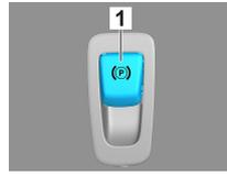
Premere il pulsante P sulla leva di selezione (1). Il freno di parcheggio viene attivato automaticamente. Il freno di stazionamento elettrico (1).
