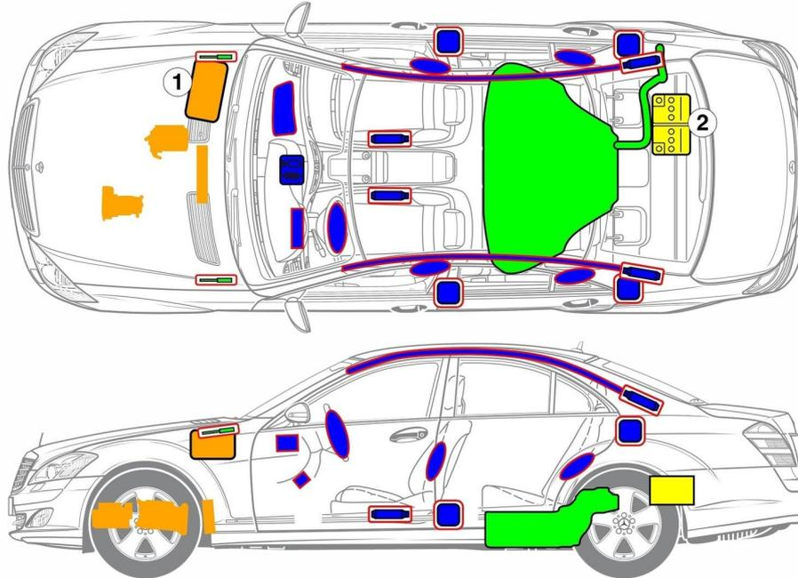
① Batteria ad alto voltaggio      ② Batteria rete di bordo 12 V
