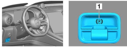
Premere il pulsante P sulla leva di selezione (1). Il freno di parcheggio viene attivato automaticamente. Il freno di stazionamento elettrico (1)
