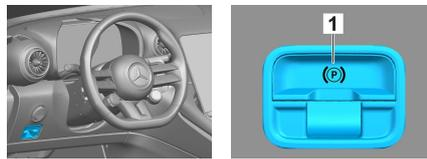
Premere il pulsante P sulla leva di selezione (1). Il freno di parcheggio viene attivato automaticamente. Freno di stazionamento elettrico (1)
