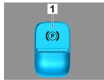
Premere il pulsante P sulla leva di selezione (1). Il freno di stazionamento elettrico (1) viene attivato automaticamente.
