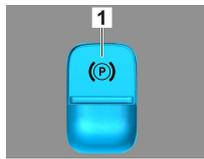
Premere la leva di selezione (1) in posizione P. Il freno di parcheggio viene attivato automaticamente.
