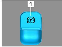
Premere la leva di selezione (1) in posizione P. Il freno di parcheggio viene attivato automaticamente. Freno di stazionamento elettrico (1)
