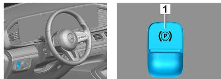
Premere il pulsante P sulla leva di selezione (1). Il freno di stazionamento elettrico (1) e il freno di parcheggio viene attivato automaticamente.
