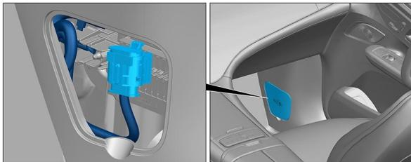
Il dispositivo di disinserimento dell'alto voltaggio si trova in basso nel montante A lato passeggero.
