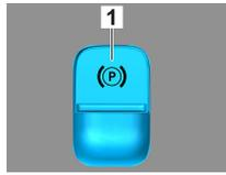
Premere il pulsante P sulla leva di selezione (1). Il freno di stazionamento viene attivato automaticamente.
