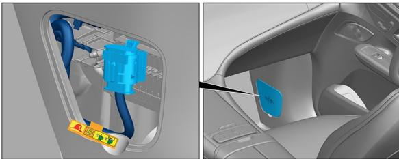
Il dispositivo di disinserimento dell'alto voltaggio si trova in basso nel montante A lato passeggero.
