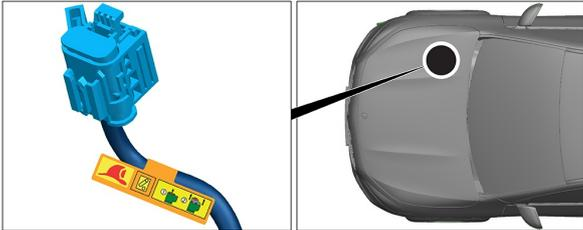
Il dispositivo di disinserimento dell'alto voltaggio si trova nel vano motore lato passeggero.
