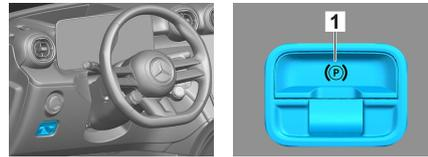
Premere il pulsante P sulla leva di selezione (1). Il freno di stazionamento elettrico (1) viene attivato automaticamente.
