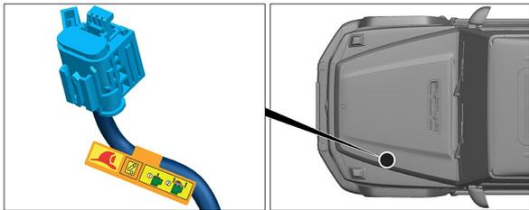
Il dispositivo di disinserimento del circuito ad alto voltaggio si trova nel vano motore sul lato guida.
