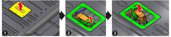
Il dispositivo di disinserimento del circuito ad alto voltaggio si trova nel vano motore sul lato guida.
