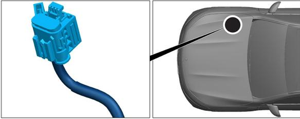
Il dispositivo di disinserimento dell'alto voltaggio si trova nel vano motore lato passeggero.
