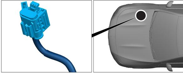
Il dispositivo di disinserimento dell'alto voltaggio si trova nel vano motore a destra in direzione di marcia.
