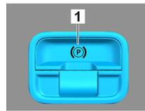
Premere il pulsante P sulla leva di selezione (1). Il freno di parcheggio viene attivato automaticamente. Freno di stazionamento elettrico (1)
