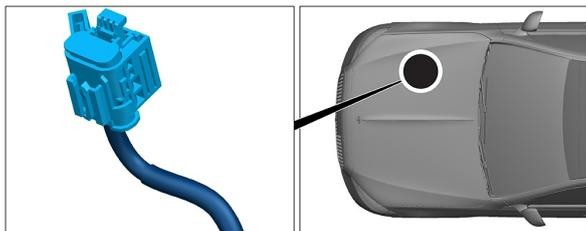
Il dispositivo di disinserimento del circuito ad alto voltaggio si trova nel vano motore sul lato guida.
