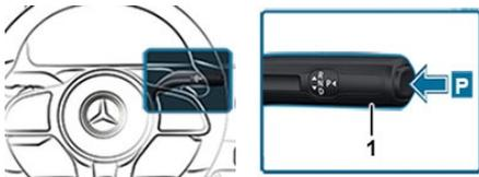
Premere il pulsante P sulla leva di selezione (1). Il freno di parcheggio viene attivato automaticamente.
