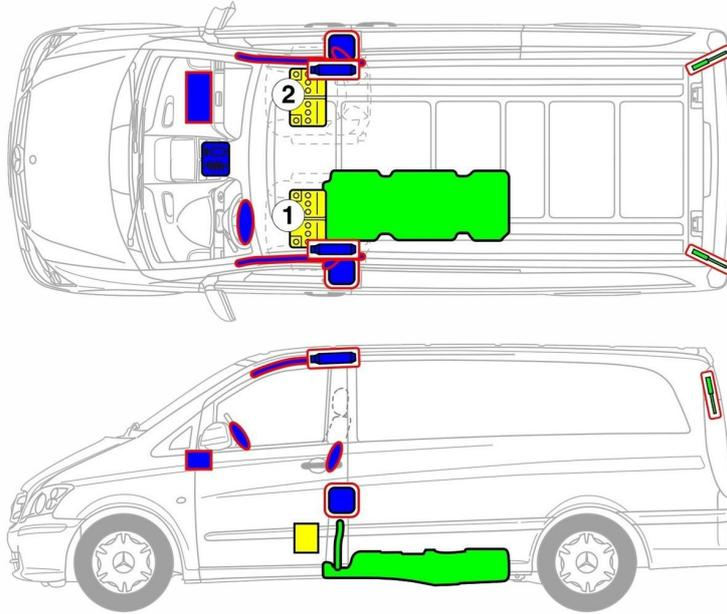
① Batteria di avviamento (Veicolo con guida a sinistra) oder Batteria supplementare (Veicolo con guida a destra)
