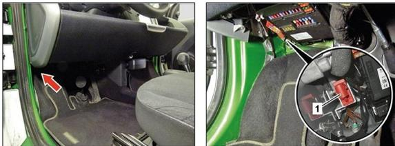
Le dispositif de coupure haute tension se trouve en dessous du tableau de bord, à gauche, vu dans le sens de marche.
