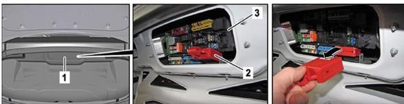
Le dispositif de coupure haute tension se trouve sous le volet de recouvrement de la boîte à fusibles et à relais, sur la paroi arrière, dans le coffre à bagages.
