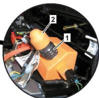
Le dispositif de coupure haute tension se trouve en haut, sur le compresseur frigorifique (3), dans le compartiment moteur, vu à gauche dans le sens de marche.
