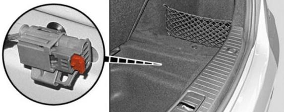
Sous le recouvrement du logement dans le coffre, à droite à l'arrière, se trouve le dispositif de coupure haute tension. Le revêtement du logement doit être retiré du coffre en tirant sur la languette située sous le seuil de chargement, au milieu du véhicule.
