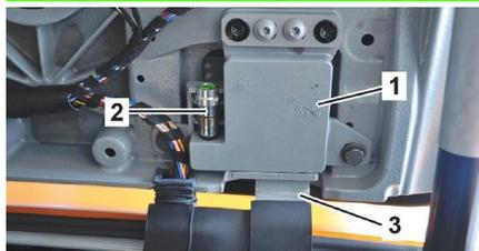
Le SLS AMG est équipé d'un système de sécurité chargé de désolidariser les charnières de porte des bras de charnière en cas de retournement du véhicule sur le toit lors d'un accident. Chaque charnière de porte (1) comporte un déclencheur pyrotechnique (2) piloté par le calculateur des systèmes de retenue. Après l'ouverture de la serrure de porte, les portes peuvent être démontées des bras de charnière (3).
