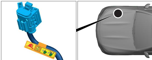
Le sectionneur haute tension se trouve dans le compartiment moteur du côté passager avant.
