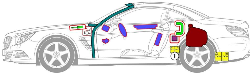
① Batterie additionnelle démarrage-arrêt ECO
