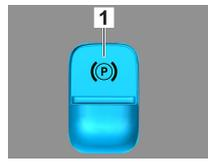
Appuyer sur le bouton P sur le levier de vitesses (1). Le frein de parking est automatiquement activé.
