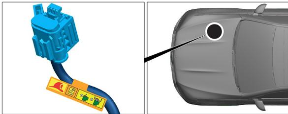
Le sectionneur haute tension se trouve dans le compartiment moteur du côté passager avant.
