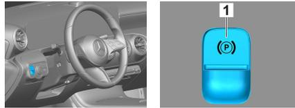
Appuyer sur le bouton P sur le levier de vitesses (1). Le frein de parking est automatiquement activé.
