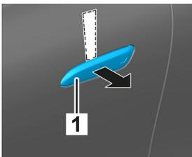
Introduire un objet plat, non métallique par en haut derrière la poignée de porte rentrée (1) et le pousser délicatement vers l'extérieur en faisant un effet de levier.
