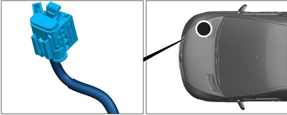
Le sectionneur haute tension se trouve dans le compartiment moteur à droite dans le sens de circulation.
