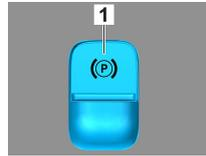
Appuyer sur le bouton P sur le levier de vitesses (1). Le frein de parking est automatiquement activé.
